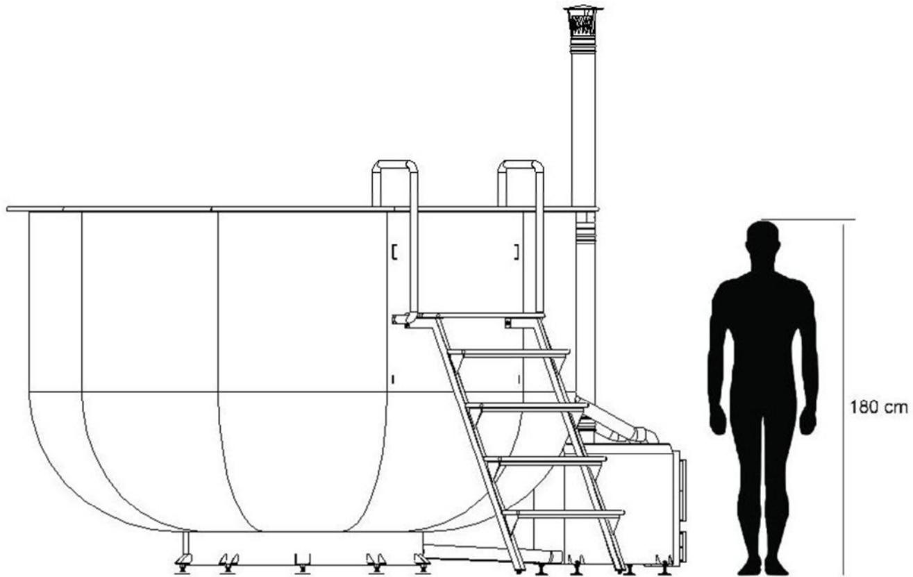
Объем воды в данном бассейне около 7,5 тонн распределится на 13 опор. Для установки бассейна, как и для других изделий, необходима первичная подготовка площадки. Обычно это бетонная армированная подушка или просто выровненная
