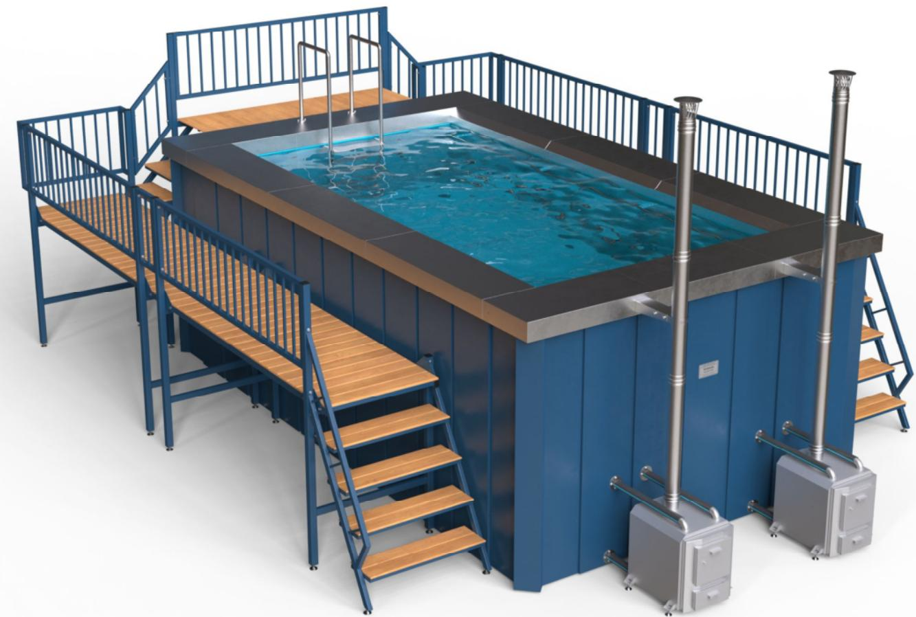
Данный водоём представляет собой стальную разборную конструкцию. Чаша выполнена из отдельных сегментов, которые скрепляются между собой на болты и гайки. Места соединений сегментов обрабатываются обычным герметиком. После сборки бассейна происходит нанесение специальной мастики толщиной в 2-3 мм, что делает чашу полностью герметичной и более мягкой на ощупь.
