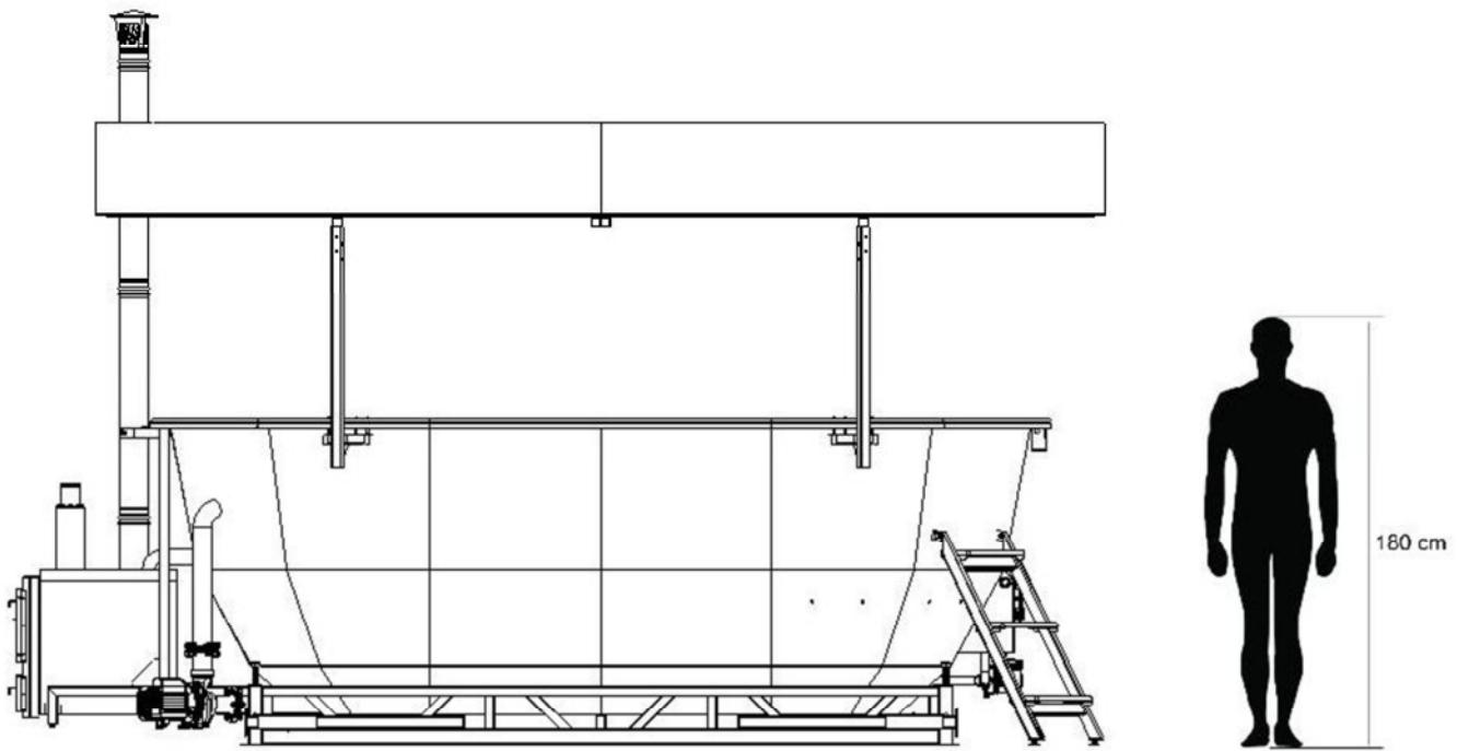
Для установки бассейна потребуется немного выровнять площадку. Объём воды в 6 тонн надо правильно разместить иначе возникнет критическая скручивающая нагрузка на раму, которая может повредить устройство.
