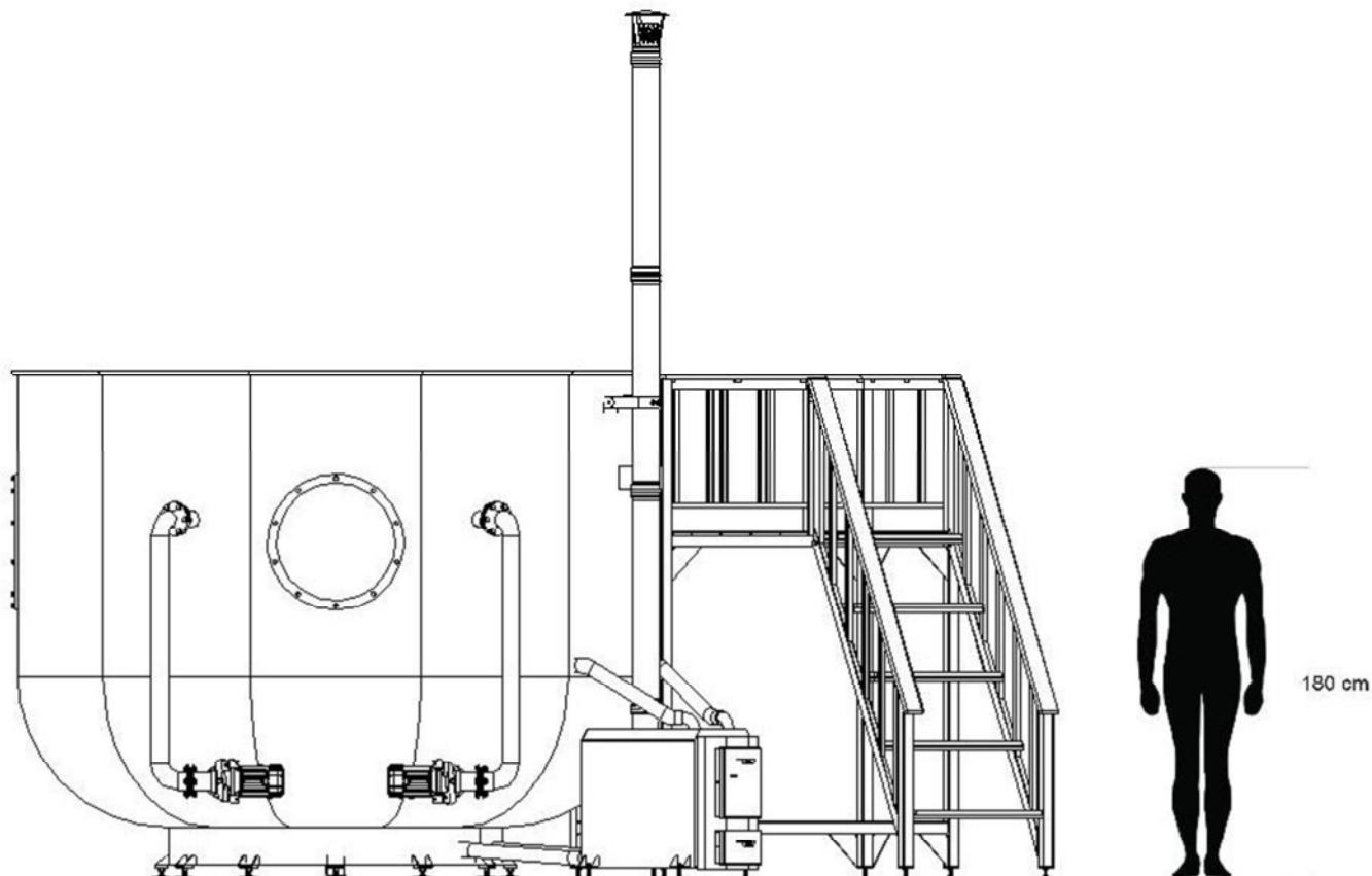
ТорOIDальная ванна это устройство для одного человека. Задача её как можно большие массы воды закрутить в торOIDальную форму.
